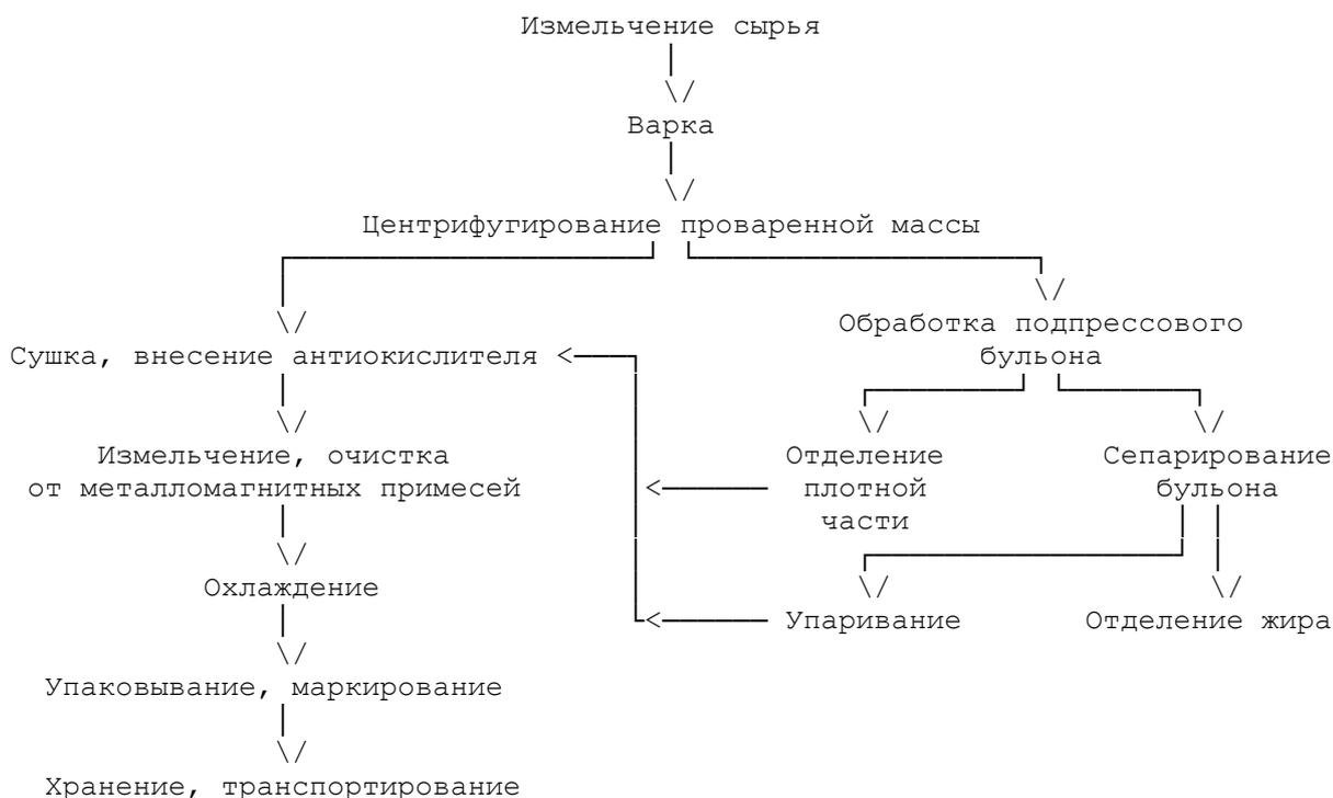
4.1. Описание технологического процесса изготовления кормовой муки центрифужно-сушильным способом.
